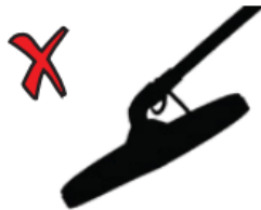
زاویه نادرست کویل جستجو
