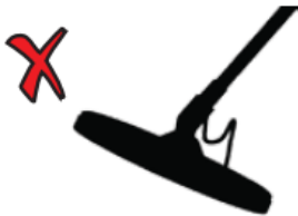
زاویه نادرست کویل جستجو
